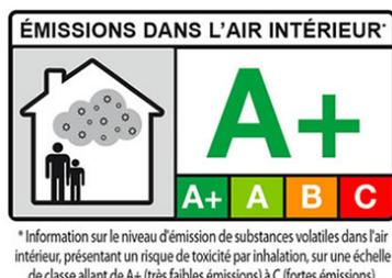
Le Syndicat National du Béton Prêt à l'Emploi (SNBPE) a demandé au Centre Scientifique et Technique du Bâtiment (CSTB) de tester les émissions de composés organiques volatils (COV) d'un béton traditionnel vibré et d'un béton autoplaçant (BAP). Les rapports d'essais du CSTB, SC13-047 pour le béton vibré, et SC13-048 pour le BAP, établissent la classification A+ (très faibles émissions) de ces bétons.
